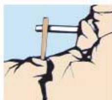
在裂缝壁上安装标尺
