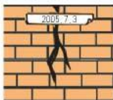
在墙体裂缝上贴纸条
