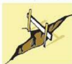
在裂缝两侧设立标杆
