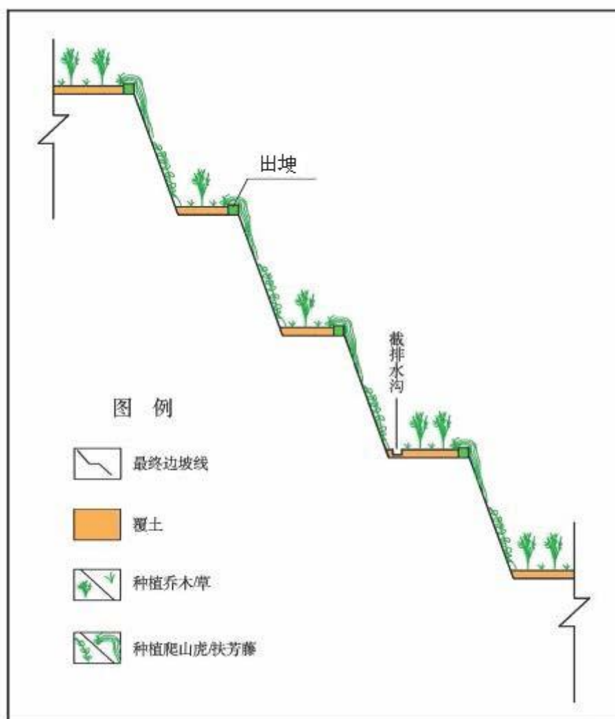
图 5.3-1 终了边坡绿化示意图（单位 cm）
